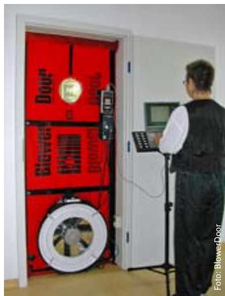
Bei der Blower-Door-Messung steht die Luftdichtheit des Passivhauses auf dem Prüfstand.
